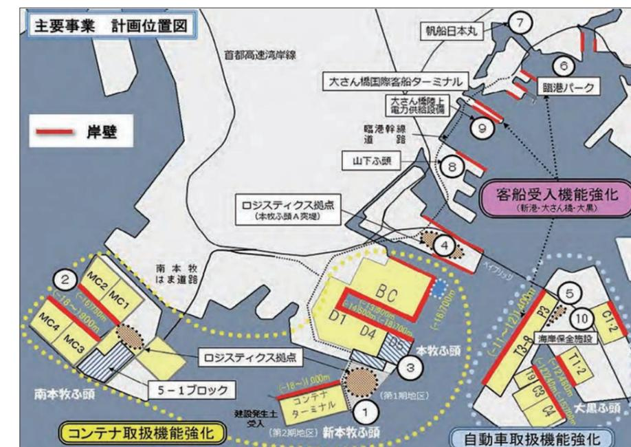
受益者負担を導入した。第2期地区（国直轄事業）は、岸壁本体の鋼板セルと護岸本体のケーソンを製作・据付する。また岸壁や護岸、荷さばき地（中仕切り）の整備に伴う海上地盤改良などを進める。一方、建設発生土受入事業では、
