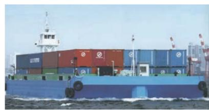
テナの横持ち輸送にあたる。いちどにトラック80台分を扱い、CO<sub>2</sub>排出削減への有力なモードで、同型のプッシャーボート3隻／コンテナバージ4隻で船隊を編成。
